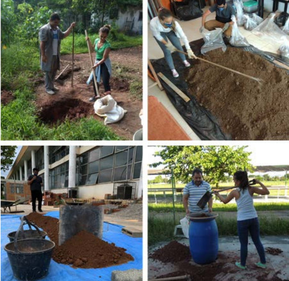
Figura 2 – Coleta do solo no terreno da Ocupação Solano Trindade e preparo do material para a produção dos BTC no laboratório.
