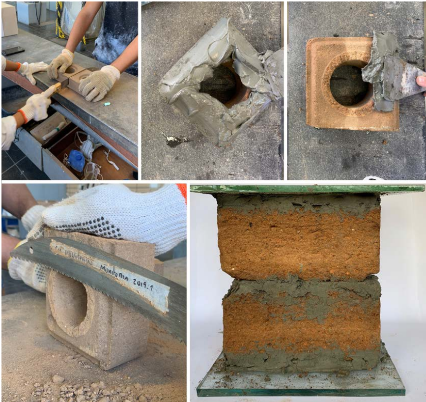
Figura 6 – Etapas do capeamento dos corpos de prova Fonte: Carvalho, 2019.
