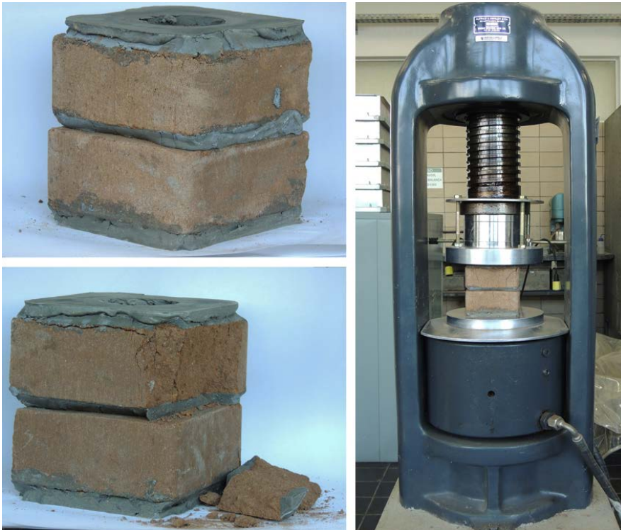
Figura 7 – Ensaio de Compressão: antes e depois do ensaio. Fonte: Carvalho, 2019.
