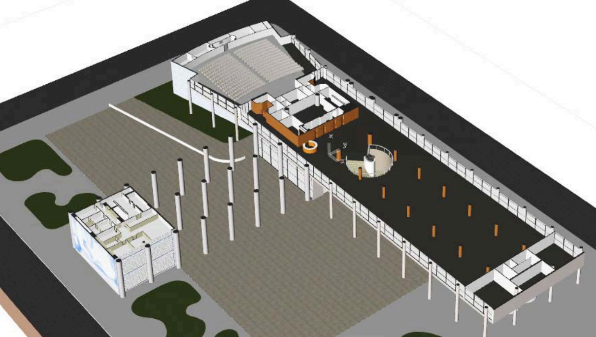
Figura 14 – Modelo BIM ilustrando corte no 9º Pavimento Fonte: CANUTO, 2017.
