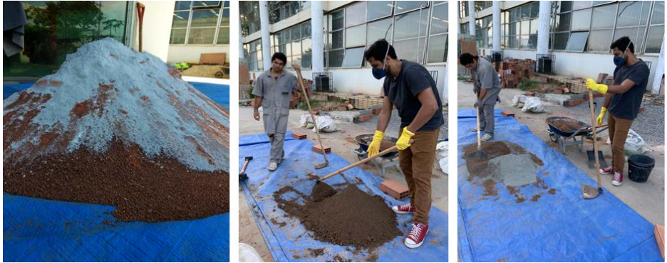
Figura 4 – Imagens que ilustram o método de preparo das misturas de solo-cimento para produção dos BTC. Fonte: Carvalho, 2019.
