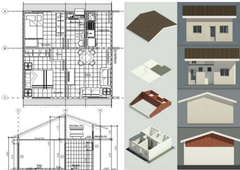
Figura 2 – Unidade Habitacional Unifamiliar – Planta Baixa, Corte A-A e Modelo 3D software 3D Autodesk Revit © 2017.
